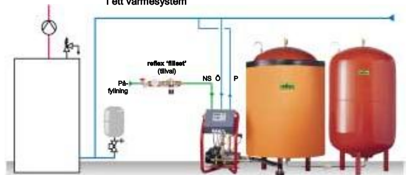
Exempel: 'variomat' inpumpningsaggregat i ett värmesystem
