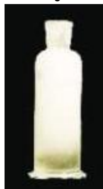
Bild 2: Kvävgasövermättat uppvärmningsvatten efter provtagningen
